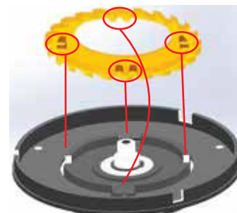
Fig. 1 Colocación de plato sembrador
