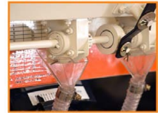
Tolvas fabricadas en Nylon de alta calidad, con diseño exclusivo que permite apreciar la descarga de semilla.
