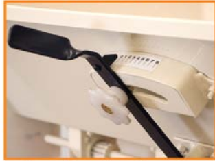
Palancas selectoras para dosificación.
