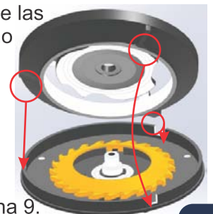
Fig. 2 Colocación de tapa sembrador
