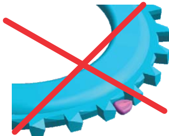
Fig. 1 Posición incorrecta de la semilla dentro de la celda
