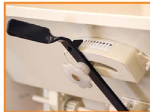
Palancas selectoras para dosificación.
