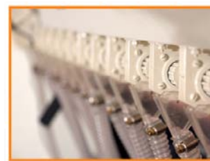
Tolvas transparentes fabricadas en policarbonato, para apreciar la descarga de semilla.
