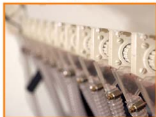
Tolvas transparentes fabricadas en policarbonato, para apreciar la descarga de semilla.
