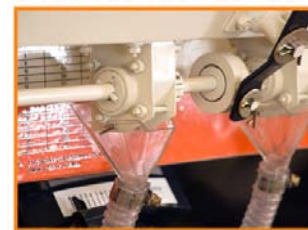
Tolvas fabricadas en Nylon de alta calidad, con diseño exclusivo que permite apreciar la descarga de semilla.
